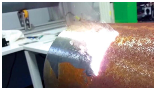
Процесс лазерной очистки поверхности трубы от ржавчины
