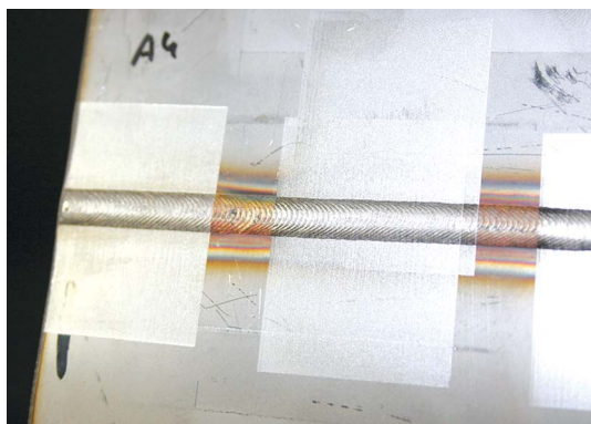
Процесс лазерной очистки сварного шва
