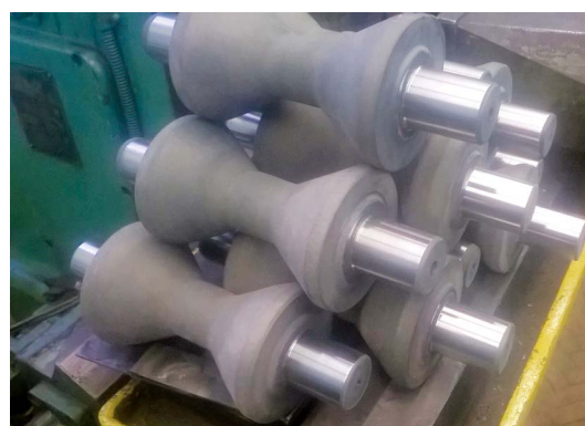
Ролики для волочения проволоки, упрочненные газопламенным напылением
