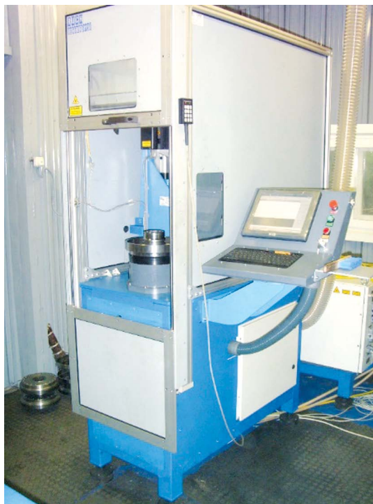
Установка лазерного термоупрочнения малогабаритных деталей ОАО «БЕЛАЗ»
