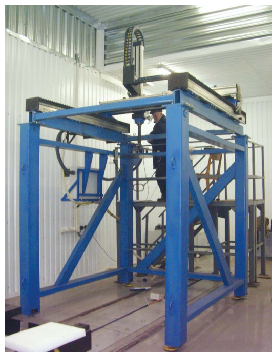
Установка лазерного термоупрочнения крупногабаритных деталей ОАО «БЕЛАЗ»
