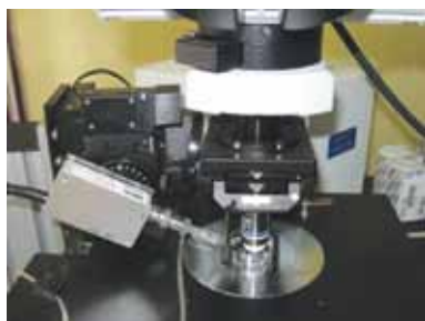
Микроскоп Olympus BX51 с манипулятором Sutter MP-225
